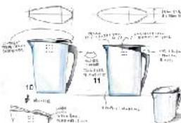
初期のスケッチ。容器を上から持ち上げる際の持ちやすさを考えた外形の幅、操作法がすぐ分かれるハンドルの形、手に沿じるハンドル部分の断面などを検討している
